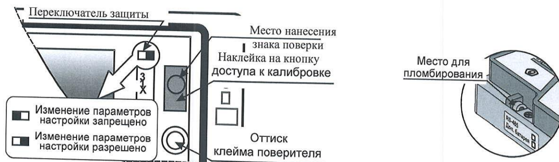
Рисунок 2 – Места пломбирования вычислителя и нанесения знака поверки
